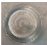
图17 SPR铆接形貌
